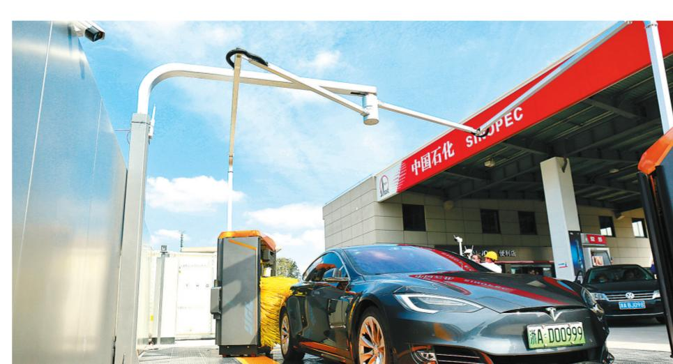
2月8日,易捷首台智能洗车机器人在杭州石油三卫路加油站投用。与传统的隧道式洗车方式不同,该设备通过传感器识别车辆,紧贴车辆运动清洗,清洁度提升至95%。此外,该设备体积较小,便于在场地有限的加油站投用。图为智能洗车机器人清洗车辆。
