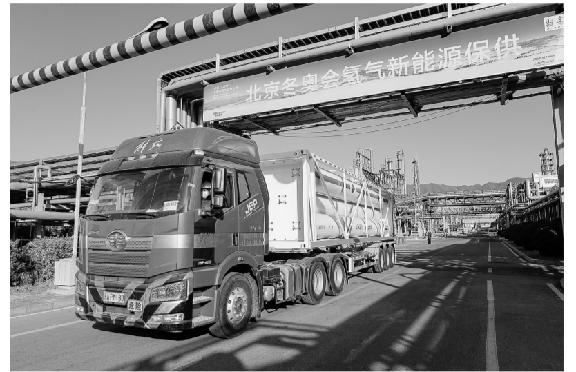
图为2月1日,燕山石化满载氢气的充装管束车顺利出厂。李雪 摄
