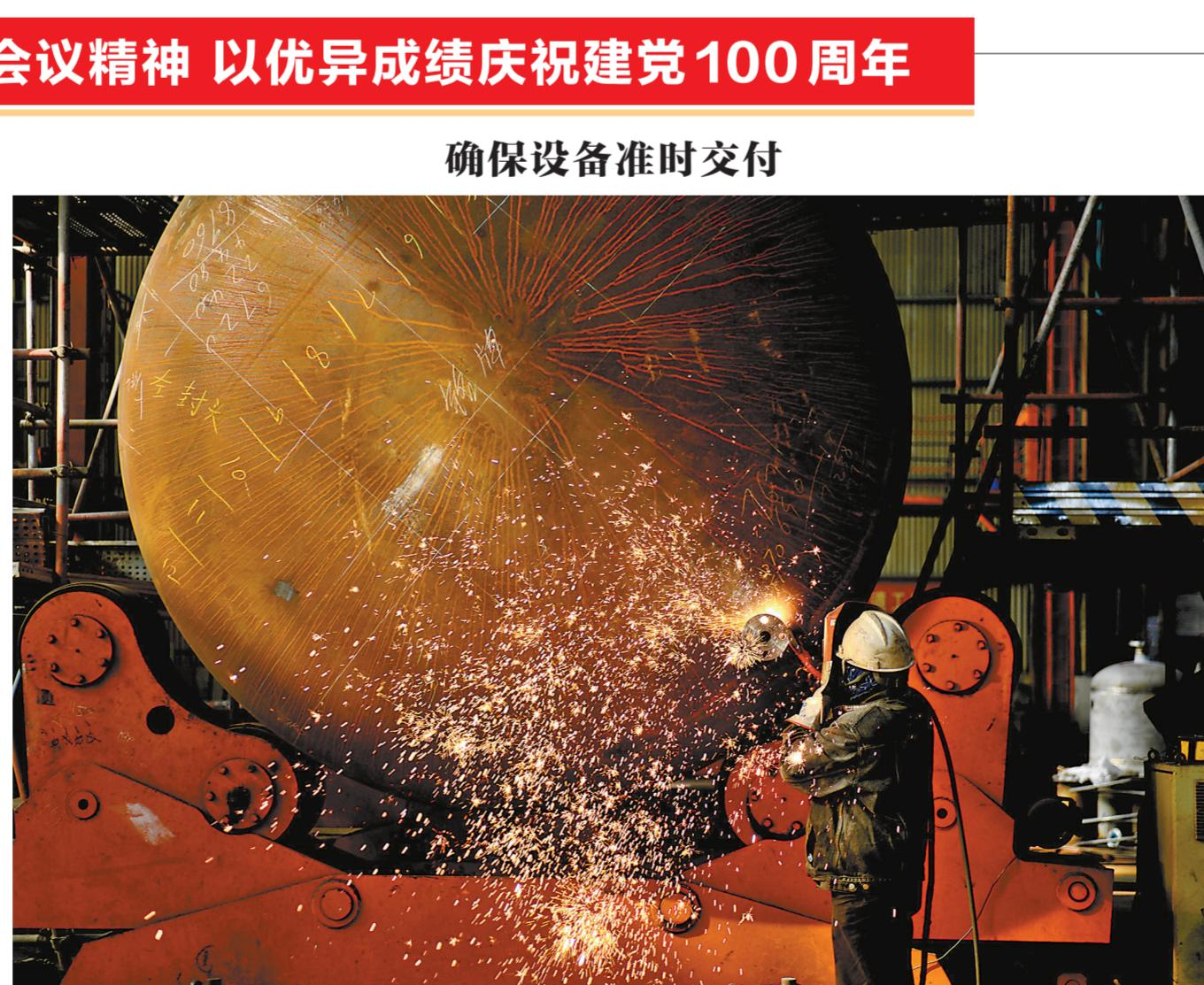
临近春节,炼化工程集团宁波工程公司宁波天翼制造公司全力攻坚,加快镇海基地项目非标设备制造加工,确保按照安装时间节点准时交付。图为1月17日作业人员对设备焊道进行气刨清根。
