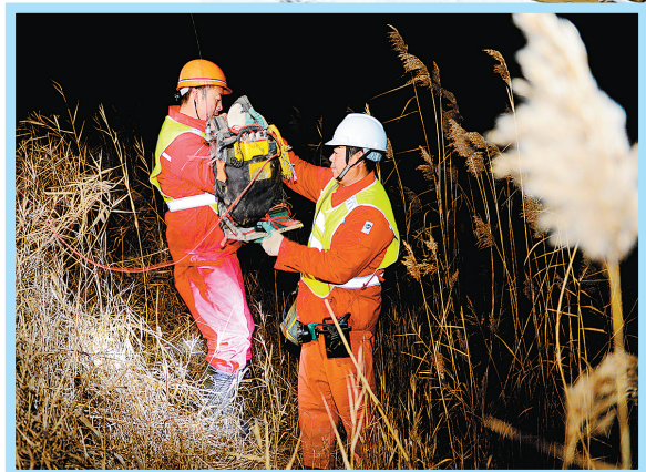
纯化三维项目,负责施工的胜利分公司SGC2101队深夜在芦苇荡里开展放炮作业。
